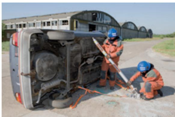
Stabilisation d'un véhicule sur le côté.
