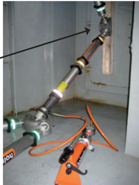
Une tête à pivot à 3 axes et un bloc à 2 axes pour utilisation plusieurs lignes d'époutillage dans différentes directions.
