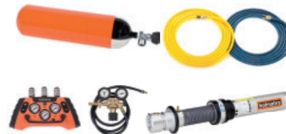
Les étais pneumatiques fonctionnent au moyen d'un système pneumatique de 8 bars, comprenant une bouteille d'air, un réducteur de pression, une unité de commande et des flexibles d'air. Capacité de charge: 100 kN / 10,1 t. Capacité de levage: 4,0 kN / 0,4 t.
