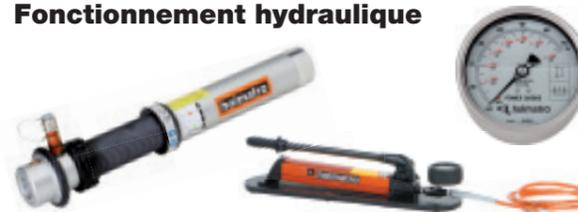
Les étais hydrauliques fonctionnent au moyen d'une pompe manuelle hydraulique de 720 bars munie d'un flexible et d'un manomètre. Le manomètre indique clairement la pression maximale autorisée pour chaque longueur d'étau. Capacité de charge et de levage: 100 kN / 10,1 t.
