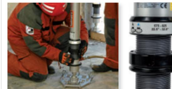
Le système de verrouillage par contre-écrou est sécurisé manuellement au moyen d'un contre-écrou. Étant donné que le système à verrouillage par contre-écrou ne nécessite pas d'autres forces supplémentaires pour être verrouillé, c'est un bon choix dans l'utilisation, par exemple, d'étauage de bâtiment effondré, où les forces en place ne doivent pas être déstabilisées afin de prévenir un second effondrement. Tous les étais peuvent être équipés avec ce type de système de verrouillage.
